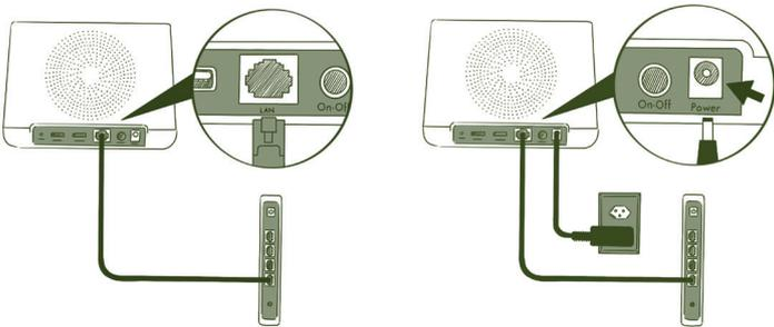
Nun können Sie durch betätigen der On-Off-Taste die Basisstation in Betrieb nehmen. Nach ca. 2 Minuten leuchten die Power-LED und Internet-LED an der Front grün auf.
